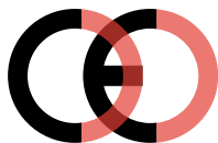
Falsche CE-Kennzeichnung (zu dicht)
