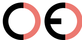
Falsche CE-Kennzeichnung (zu großer Zwischenraum)
